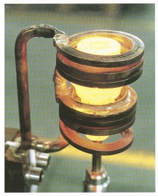
Fig. 2. – Chauffage en surface d'une tête de forage. Les temps de chauffe sont d'environ 20 secondes, avec un courant de plusieurs milliers d'ampères
