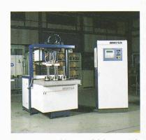
Fig. 4. - Machine modulaire pour le chauffage par induction. On distingue à gauche le corps de la machine et les inducteurs, à droite le générateur et la commande.
