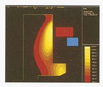
Fig. 6. – Simulation des flux de température dans un axe, au passage de l'inducteur puis de la douche (pièce montrée à la figure 1)
