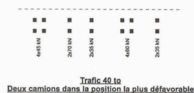
Fig. 8. – Situation de risque due au trafic routier de 40 t (véhicules types choisis dans l'EUROCODE 1)
