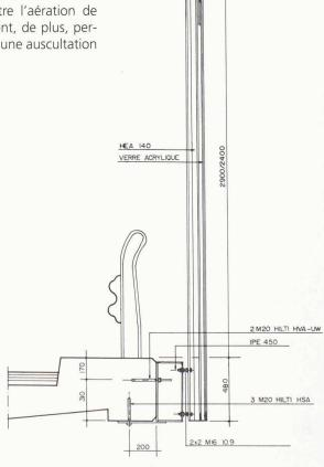
Fig. 5.- Fixation de la paroi, h = 2,50-3,00 m
