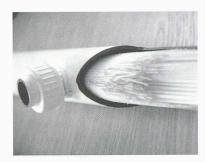
Module d'ultrafiltration: chaque module contient 18 000 fibres, soit 65 m² de surface de filtration. (Photo: IAS)
