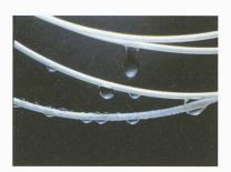
Filtration de l'eau par membranes: l'eau brute est injectée dans les fibres creuses et traverse les parois poreuses
