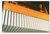
Carreaux de plâtre en cours de fabrication.
