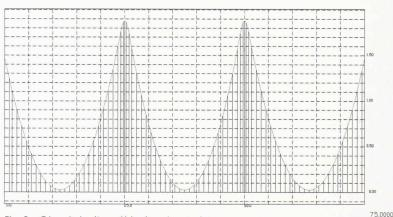
Fig. 3.- Géométrie d'un câble de précontrainte
