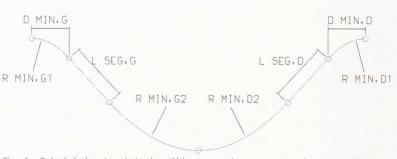
Fig. 4.- Calcul de la géométrie des câbles avec prise en compte des rayons de courbures minimaux
