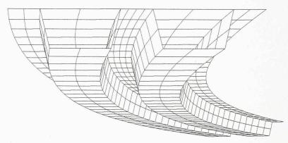
Fig. 1a.- Vue en perspective d'un pont caisson courbe
