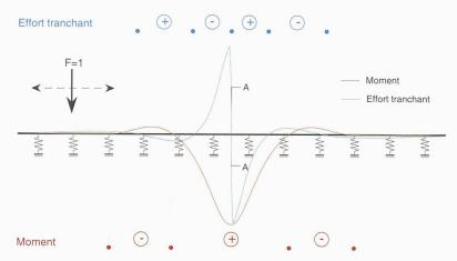
Fig. 12. - Ligne d'influence du moment de flexion et de l'effort tranchant longitudinal pour le modèle de charge 1
