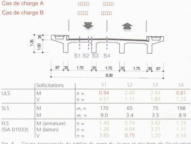
Fig. 6. - Coupe transversale du tablier du pont du Javroz et résultats de l'évaluation selon les états limites ULS, SLS et FLS
