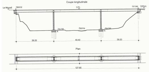
Fig. 7. - Plan d'ensemble du pont sur la Gérine
