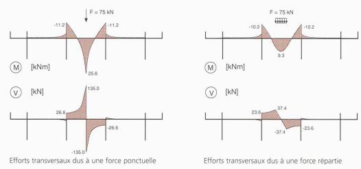
Fig. 10. - Comparaison des efforts dus à la charge d'une roue (Pont du Javroz)
