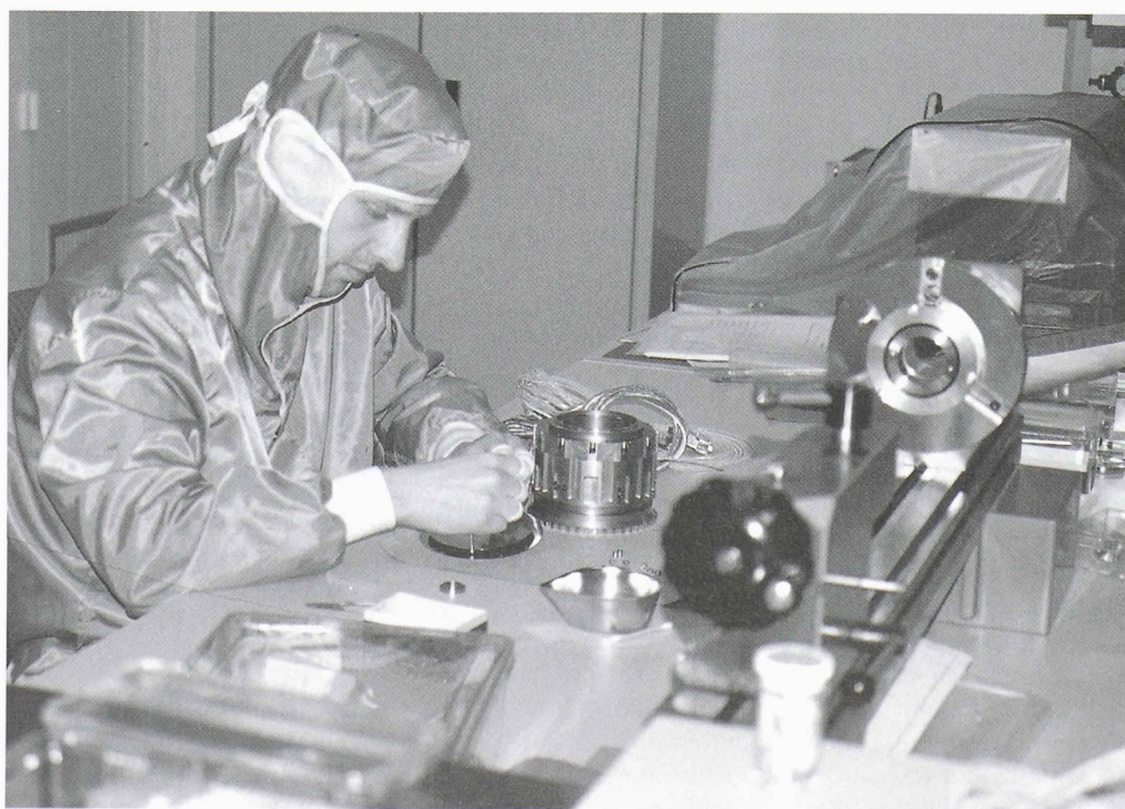
Montage chez ETEL du moteur destiné au bras robotique embarqué dans la station spatiale internationale
