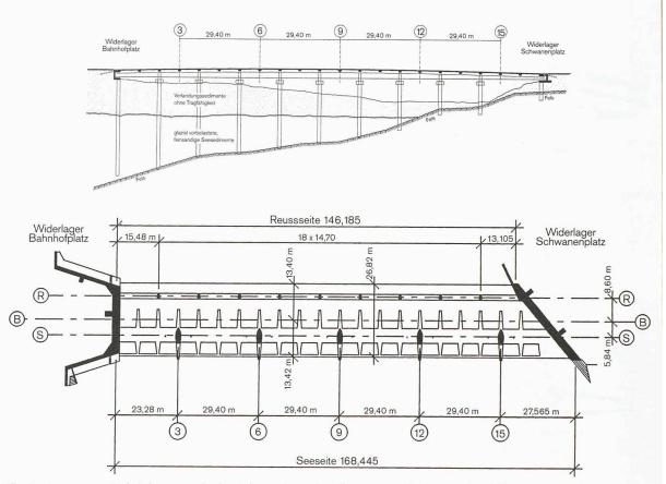
Fig. 4. - Le nouveau Seebrücke: coupe horizontale au niveau des piles avec vue du dessous du tablier et coupe en long
