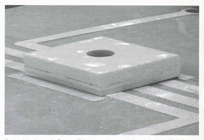
Capteur/régulateur de flux en silicium, monté sur une base hybride (taille inférieure à 5 mm), développé conjointement avec l'Institut de microsystèmes (document Medtronic)
