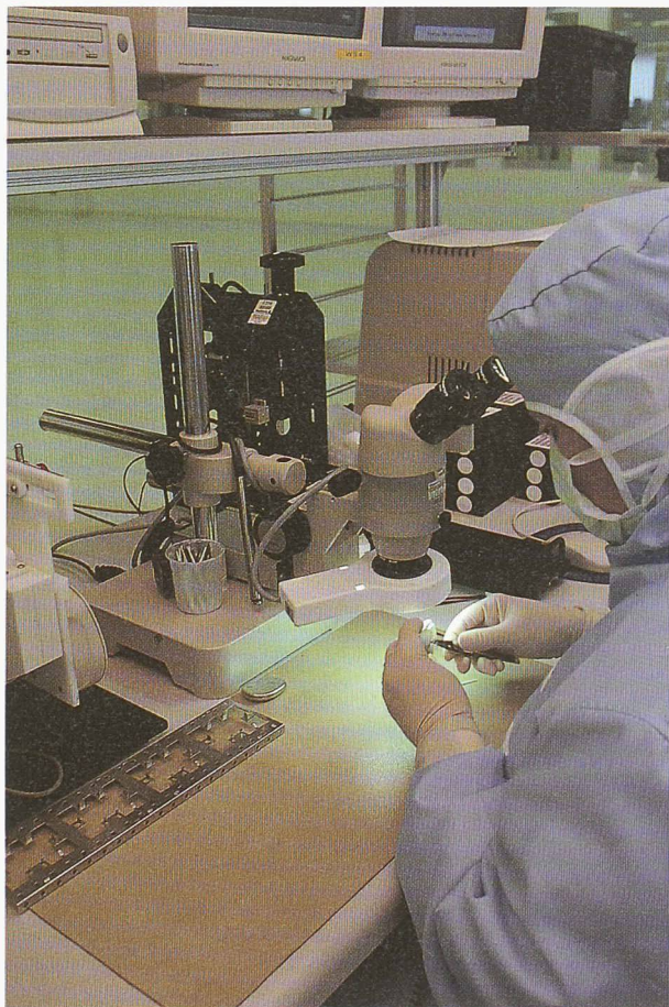
L'électronique destinée aux stimulateurs cardiaques est encapsulée dans une boîte en titane et soudée au laser
