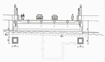
Fig. 6. – Pont sur la Saltine: coupe transversale
