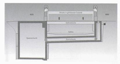
Fig. 7. – Pont sur la Saltine : coupe longitudinale montrant le pont dans sa position normale et en position haute
