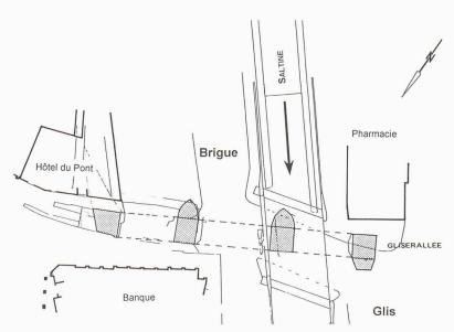
Fig. 3. – Pont sur la Saltine : plan de situation montrant également l'emplacement des vestiges d'un ancien pont à trois arcs datant des XVe et XVIe siècles
