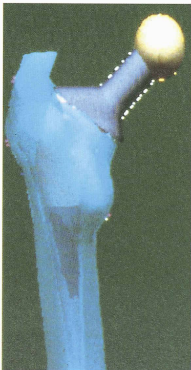
Fig. 2 – Simulation du processus d'insertion de la prothèse, avec le logiciel développé par Symbios
