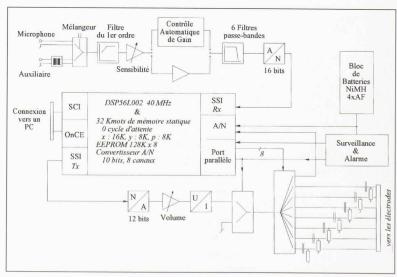
Fig. 4 – Schéma électronique général du dispositif portable
