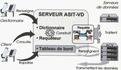
Fig. 1.- Schéma de fonctionnement du SIT-VD
