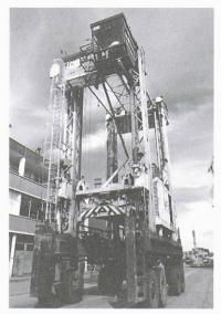
Ces engins sur pneus, capables de lever et d'entasser des conteneurs jusqu'à trois couches, desservent les autres quais que celui du terminal spécialisé.
