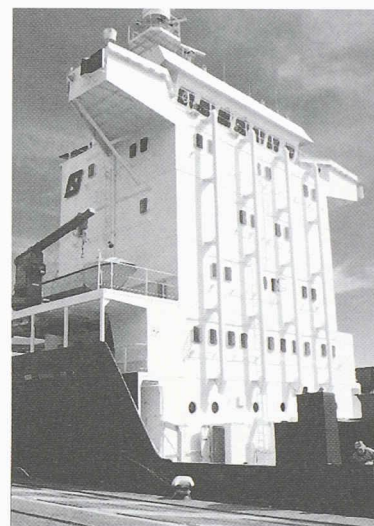
Le Slo-man Commander à quai à Amsterdam (à gauche). La partie « habitable » du navire compte six niveaux (à droite).
