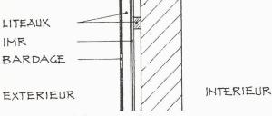
Fig. 9. - IMR sur la face externe d'un mur
