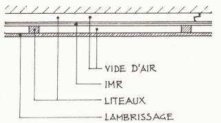
Fig. 6. – Mise en œuvre d'une IMR
