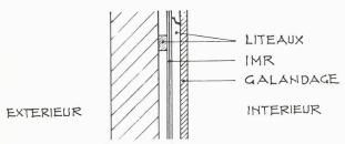
Fig. 8. - IMR sur la face interne d'un mur
