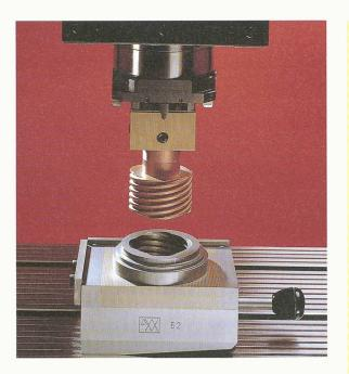
Fig. 2 – Machine à électro-érosion par enfonçage
