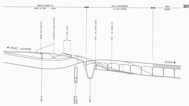
Profil en long, à l'échelle déformée, de la transition entre la tranchée couverte du Bachet-de-Pesay et la Voie-Centrale avec les ouvrages et leurs rampes d'accès
