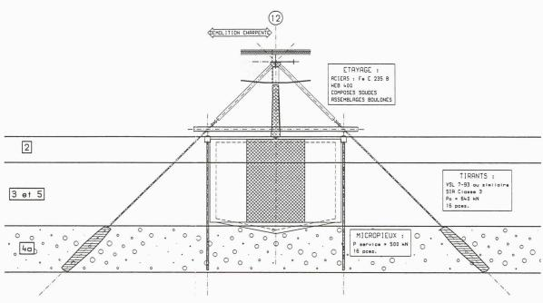
Point fixe provisoire: élévation. L'ouvrage travaille en traction; une base faite de micropieux, de puits de fondations et d'ancrages précontraints est clouée au sol. Des tirants métalliques en biais coulissent librement dans la base tant que l'ouvrage n'est pas bloqué, des butées de sécurité limitant les mouvements possibles en cas d'erreur de manipulation.
