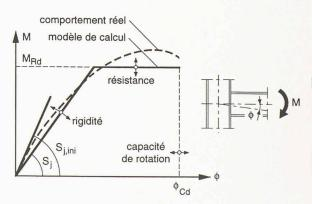
Fig. 2. – Paramètres de l'approximation bilinéaire de dimensionnement
