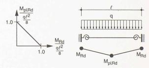
Fig. 10. – Analyse plastique d'une poutre avec assemblages d'extrémité semi-rigides
