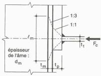
Fig. 7. – Assemblage poutre-poteau par plaque frontale débordante
