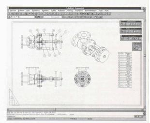
Autodesk Mechanical Desktop simplifie considérablement la création de dessins d'ensemble ou de détail en générant automatiquement les différentes vues à partir du modèle 3D. L'illustration ci-dessus décrit l'assemblage automatique de différentes pièces. Les vues isométriques, coupes et vues de détail peuvent être générées aussi facilement. Les cotations définies pour le modèle sont insérées automatiquement. Des cotations complémentaires peuvent être rajoutées.
