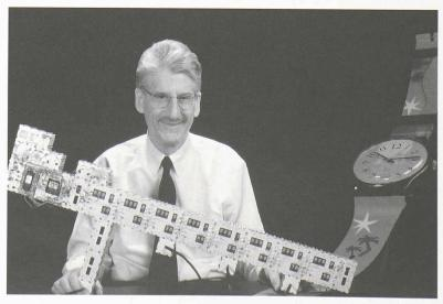
Le professeur Daniel Mange tenant un prototype de laboratoire de la Biowatch, dans une version affichant les heures, minutes et secondes, avec deux cellules pour la réparation (Photo: J.-C. Revy, Paris)
