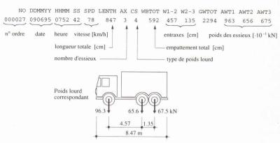
Fig. 2. - Exemple de résultats bruts fournis lors du passage d'un poids lourd à trois
