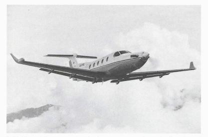
Le PC-12 en vol. On remarque les volets hypersustentateurs de grandes dimensions qui permettent de combiner une vitesse de croisère élevée avec la faible vitesse de décrochage prescrite par les normes d'homologation.
