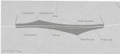
Fig. 3. – L'île artificielle a une forme soigneusement étudiée: variantes à deux îles reliées par un pont et à une seule île
