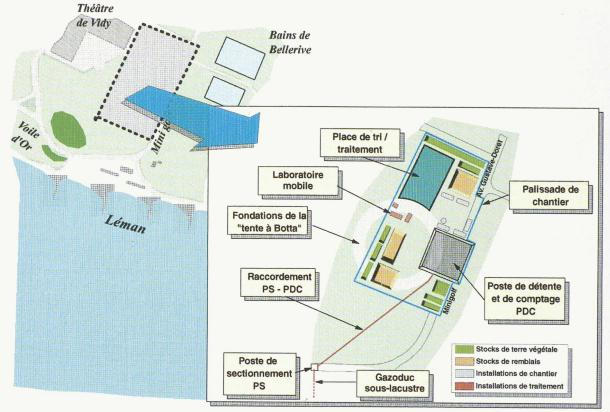
Fig. 1.- Localisation du projet et vue en plan du chantier de l'atterrage du gazoduc
