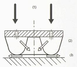
Principe de fonctionnement des coussins d'air: Le flux d'entrée d'air (1) gonfle la membrane souple (2). Le flux d'air qui s'échappe forme un film d'air (3) sur lequel la charge glisse.
