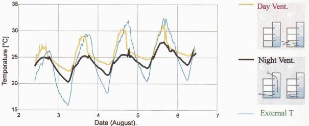
Fig. 2.- Température dans deux bureaux identiques. L'un est aéré pendant la journée, l'autre pendant la nuit. L'abaissement de la température maximale dépasse 4 degrés! La ligne fine est la température extérieure.
