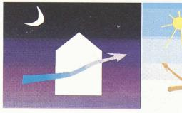
Fig. 1.- Les deux périodes du refroidissement passif : à gauche, période de refroidissement, à droite, période de protection
