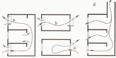
Fig. 4.- Configurations de ventilation naturelle: a) ventilation à deux ouvertures; b) ventilation traversante; c) ventilation à ouverture unique; d) ventilation avec cheminée
