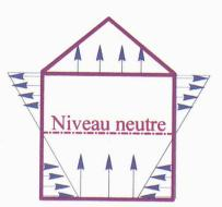
Fig. 3.- Position du niveau neutre
