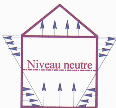
Fig. 3.- Position du niveau neutre
