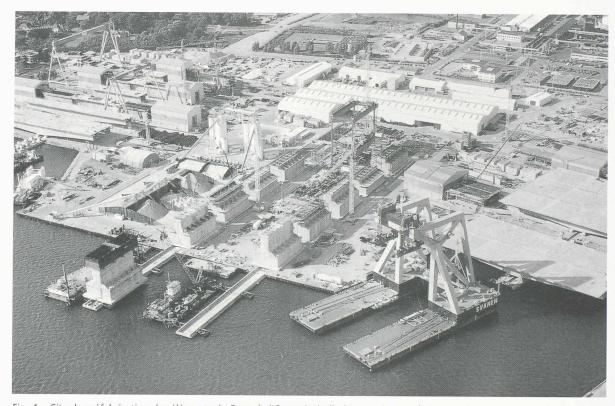
Fig. 4. - Site de préfabrication des éléments du Pont de l'Ouest à Lindholm avec la grue flottante « Svanen » au premier plan (Photo: A/S Storebaeltsforbindelsen)
