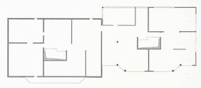
Fig. 11 - Représentation des porteurs : murs et colonnes
