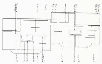
Fig. 10 - Plan d'armatures correspondant aux nappes des figures 8 et 9
