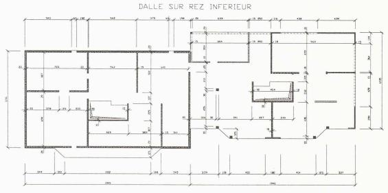
Fig. 2. - Plan de coffrage
