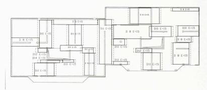
Fig. 9 - Nappes supérieures selon la direction X
