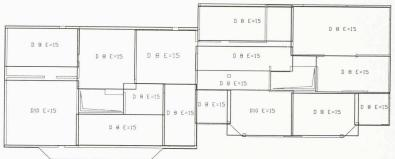
Fig. 8 - Nappes inférieures selon la direction X
