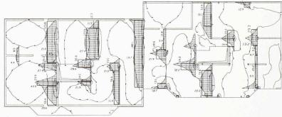
Fig. 7 - Intégration des moments d'armature ( - Mx + IMxyl) pour la nappe supérieure
