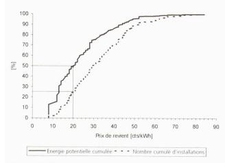
Fig. 4.- Courbes cumulées de l'énergie potentielle et du nombre d'installations en fonction du prix de revient du kWh
