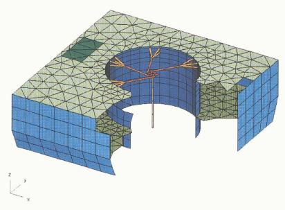
Fig. 4. - Modélisation par éléments finis de la structure du génie civil pour les calculs dynamiques
