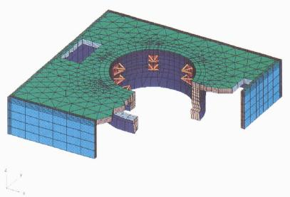
Fig. 3. - Modélisation par éléments finis de la structure du génie civil pour le calcul de la rigidité des appuis du palier supérieur
