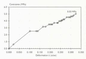
Fig. 9. - Essai de traction avec fluage (durée 18 jours)
