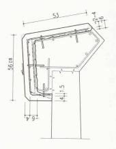
Fig. 3. - Coupe de la bordure à réparer
