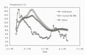
Fig. 6. - Mesure de la température d'hydratation initiale du mortier
