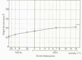
Fig. 7. - Essai d'absorptions en fonction du temps
