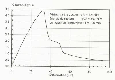
Fig. 10. - Essai de traction pure/déformation lente contrôlée (effectué au Laboratoire IBWK de l'EPFZ, prof. F.H. Wittmann)
