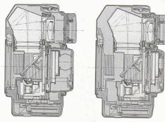
Position de base du châssis autofocus mobile
