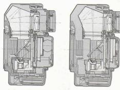
Position de base du châssis autofocus mobile
