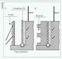
La natte s'adapte sans peine à n'importe quel sous-sol, est imputrescible et d'une mise en œuvre aisée. L'utilisation d'Enkadrain CK est ainsi liée à de nombreux avantages: volume d'excavation réduit, étanchéification de la paroi extérieure superflue, pas de couche de filtrage et de drainage, ni d'obturation de fouille.
