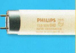
Les tubes fluorescents de la nouvelle génération TLD 80 NG proposent une véritable innovation. Car leur flux lumineux reste quasiment constant pendant toute leur durée de vie. Et ceci, grâce à une nouvelle technique d'application des poudres qui permet également de réduire la quantité de mercure de 80%. Résultat: l'exploitation de l'installation d'éclairage plus économique, un rendement lumineux élevé et un très bon rendu des couleurs. Les nouveaux tubes fluorescents TLD 80 NG. B 5469
