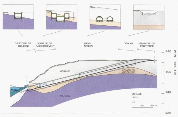
Figure 2. - Tunnel de liaison Bellefontaine – Frontenex: stratigraphie
