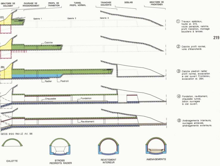
Figure 7. - Tunnel de liaison Bellefontaine – Frontenex: phases de construction
