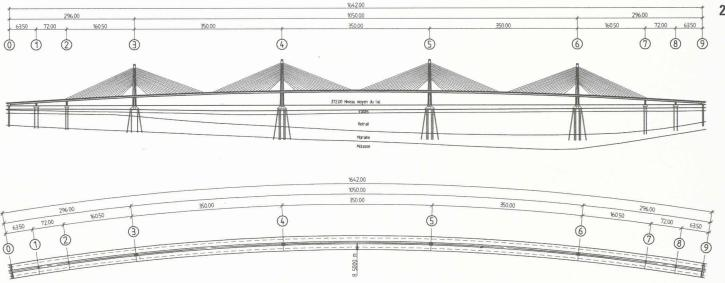
Figure 3. - Pont haubané: situation en plan et élévation
