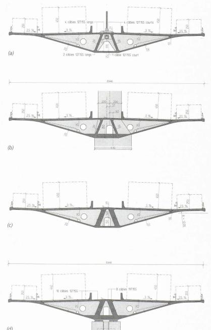
Figure 6. - Coupe transversale du tablier (a) en milieu de travée du pont haubané (b) au droit d'un pylône (c) en milieu de travée du viaduc d'accès (d) sur appui
