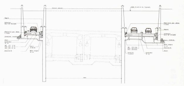
Figure 6. - Trémies à ciel ouvert au plateau de Frontenex: coupe type
