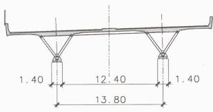
Fig. 17. - Coupe type pour une transparence optimale
