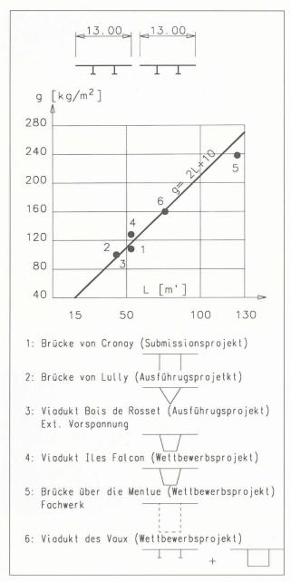
Fig. 27. - Contrôle du poids des aciers
