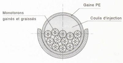
Fig. 12. - Câble de précontrainte - coupe au dessus d'un siège
