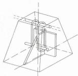
Fig. 3. - Joint type et goujon de cisaillement
