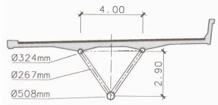
Fig. 19. - Coupe type du pont
