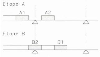
Fig. 9. - Etapes de bétonnage
