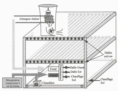
Fig. 2.- Réseau de distribution de chaleur et de froid du bâtiment
