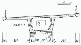
Fig. 3. - Coupe type du caisson: solution initiale
