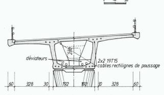
Fig. 5. – Coupe type du caisson: variante d'entreprise
