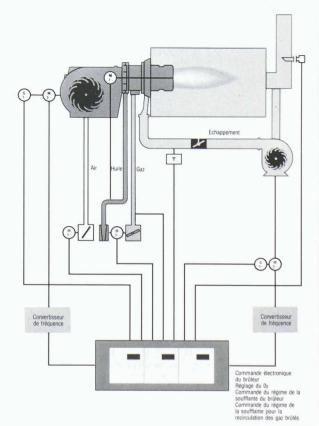
males pour toute la plage de puissance du brûleur. Afin d'optimiser le rendement et de réduire les émissions polluantes, les brûleurs à commande électronique interconnectée peuvent être complétés par le dispositif de recyclage des gaz brûlés et la commande pour la régulation de l'O<sub>2</sub> et du nombre de tours (halle 321, stand A32).
