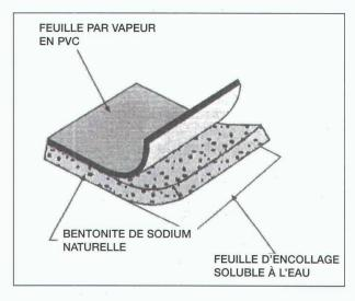
Les Membranes d'étanchéités *SWELLTITE* de *VOLCLAY* sont composées de trois couches liées, soit d'une feuille de protection, d'un aggloméré de Bentonite de Sodium naturelle (Monmorillonite) avec du caoutchouc butyl et d'un film d'encollage soluble à l'eau.
