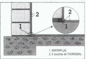
THOROSEAL, des enduits à base de ciment pour étancher les constructions soumises à des pressions ou infiltrations d'eaux.
