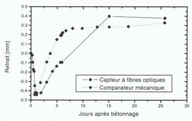
Fig. 7. - Mesure du retrait du tirant. Dès le bétonnage, le capteur interne à fibres optiques mesure le gonflement du béton dû à la chaleur d'hydratation, tandis que les comparateurs mécaniques n'entrent en fonction qu'après le durcissement du béton.
