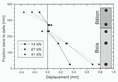
Fig. 11. - Diagramme des déformations sur les 3 m centraux de la poutre en fonction de la charge. Le diagramme en Z caractéristique d'une section mixte se remarque nettement.
