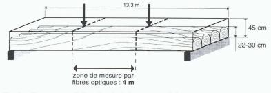
Fig. 9. - Test sur une dalle mixte bois-béton en collaboration avec l'IBOIS. La dalle est composée de quatre poutres en bois, d'une chape de béton de 15-20 cm et de connecteurs. Les fibres optiques mesurent le déplacement sur les 3 m centraux afin d'en déduire le diagramme des déformations.
