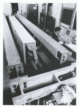
Fig. 6. - Test sur des tirants en béton armé et précontraint en collaboration avec l'IBAP. Les valeurs de déformation données par les capteurs à fibres optiques sont directement comparées à celles fournies par des jauges à induction pilotant l'essai en traction.
