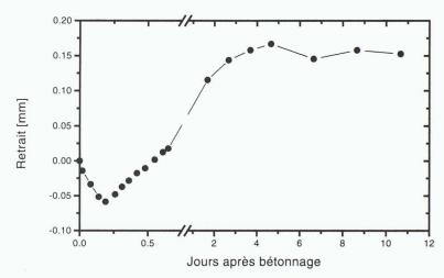
Fig. 13. - Mesure du retrait de la dalle de roulement du pont mixte. La phase de gonflement du béton se distingue nettement.
