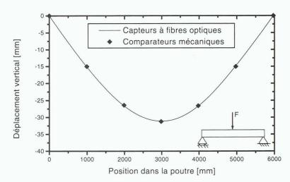
Fig. 15. - Résultat de l'algorithme pour une poutre simple ponctuellement chargée. Comparaison entre la déformée mesurée par fibres optiques et la déformée mesurée en cinq points par des comparateurs mécaniques.
