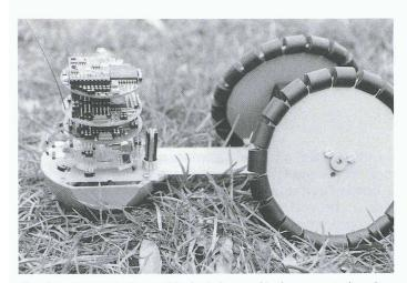
Fig. 5. - Maquette Pemex-BS destinée au développement des algorithmes de navigation
