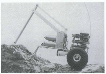
Fig. 6. - Maquette du Pemex-W pour terrains très accidentés
