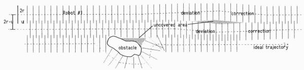
Fig. 8. - Scénario de recherche de mines par trois Pemex-2 semi-autonomes
