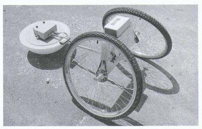
Fig. 7. - Robot Pemex-B avec un détecteur de métal simple: la tête oscille de droite à gauche pour balayer un espace de recherche plus large que le robot.
