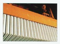
Carreaux de plâtre en cours de fabrication.
