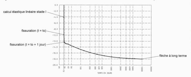
Fig. 6. – Évolution de la flèche de la dalle unidirectionnelle dans le temps
