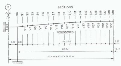
Fig. 12. – Modèle statique en «BARRE» 3D de la console pour les calculs non-linéaires avec numérotation des sections et des voussoirs
