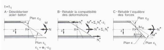
Fig. 2. – Effet du fluage au premier pas de temps sur une section non fissurée sollicitée en flexion composée
