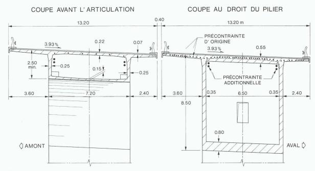
Fig. 9. – Coupe transversale au droit de l'articulation et de la pile
