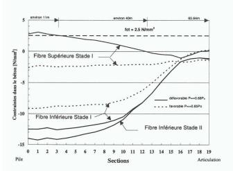
Fig. 16. – Contraintes dans le béton le long de la console
