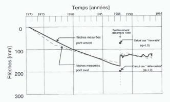
Fig. 15. – Comparaison des flèches mesurées et calculées
