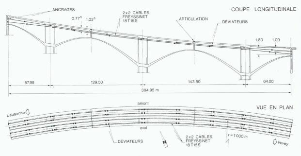
Fig. 10. – Schéma de la précontrainte extérieure de renforcement
