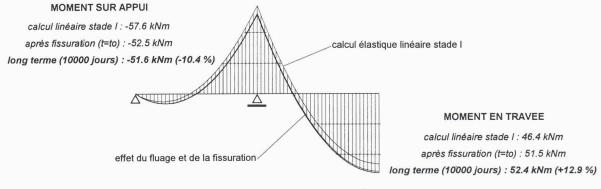
Fig. 7. – Redistribution des moments de flexion de la dalle unidirectionnelle
