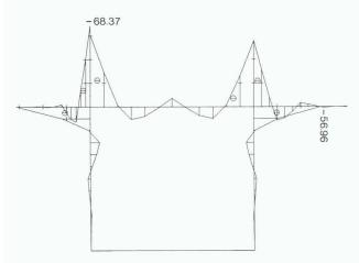
Fig. 14. – Distribution des contraintes en kg/cm² au droit de l'ancrage des câbles (modèle «COQUE»)
