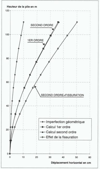
Fig. 19. – Déformation de la pile élancée sous: 1.0\* poids propre + 1.0\* vent
