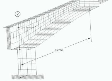
Fig. 11. – Modélisation en «COQUE» de la console pour les calculs élastiques linéaires
