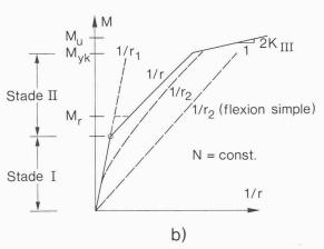
Fig. 1. – Relations moment-courbure CEB-FIP: a) flexion simple (N = 0); b) flexion composée avec un effort normal de compression (N < 0)
