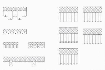
Fig. 6. – Variantes de plafond en bois résultant de la mise en œuvre de la dalle bois ou de la dalle mixte bois-béton. Le marquage du joint dans certains cas utilisant des planches permet de renforcer le joint d'ombre qui ne manquera pas de se former avec les variations hygroscopiques et dimensionnelles du bois.
