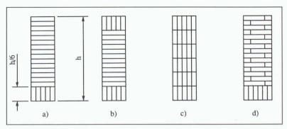
Fig. 4. – Schéma de principe du bois lamellé-multicollé (BLMC) avec une ou plusieurs semelles composées de lames verticales, en particulier dans les zones tendues.
