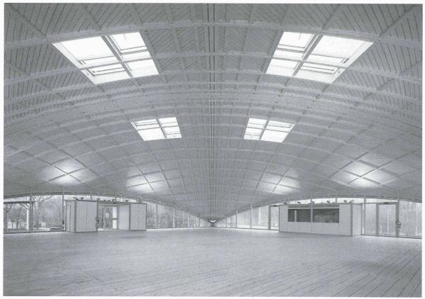
Fig. 1. – Polydôme de l'EPFL, réalisé à l'occasion du 700° anniversaire de la Confédération et destiné, à l'époque, à recevoir l'exposition «Miroir des techniques». Il est basé sur le système statique d'une grille de planches cintrées. L'épaisseur de chaque nervure contient seulement quatre planches de 27 mm vissées. (Architectes: D. Badic et associés, Morges; ingénieurs: J. Natterer et Bois Consult Natterer, Etoy) (Photo H. Germond)
