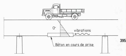
Fig. 11. - Pont en service durant les réfections
