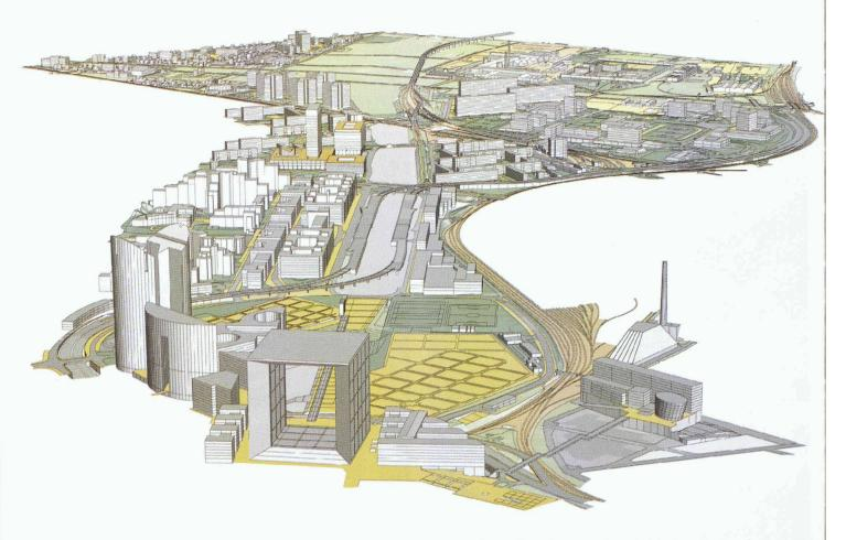
Fig. 6. - EPAD (Etablissement public pour l'aménagement de la Défense): perspective générée à partir d'un fichier contenant des données en provenance de diverses sources: photogrammétrie aérienne, plans cadastraux et relevé télémétrique
